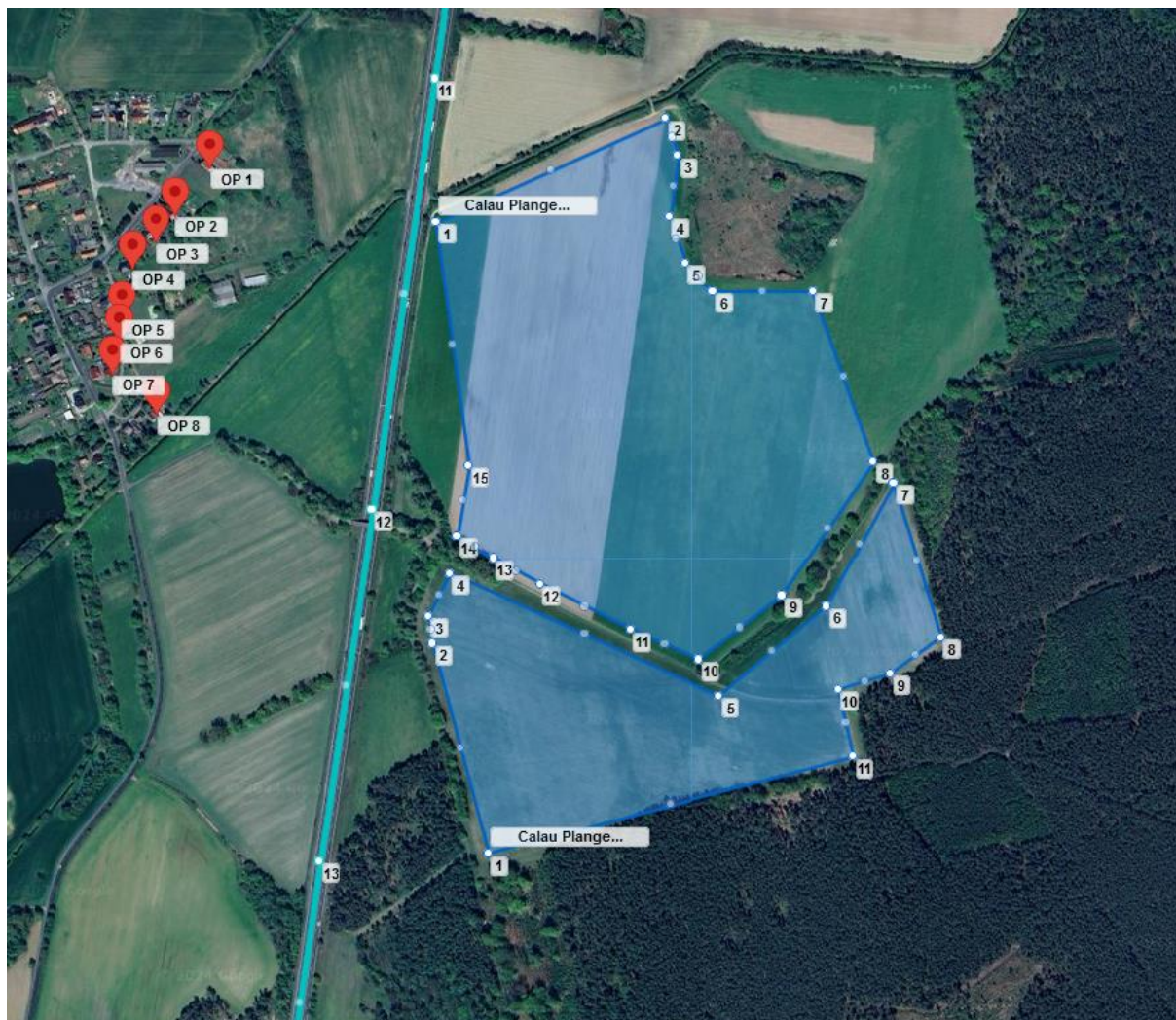
Abbildung 16: Anlage der PV-Flächen für Plangebiet 3 und Immissionsorte in der Simulationssoftware ForgeSolar
