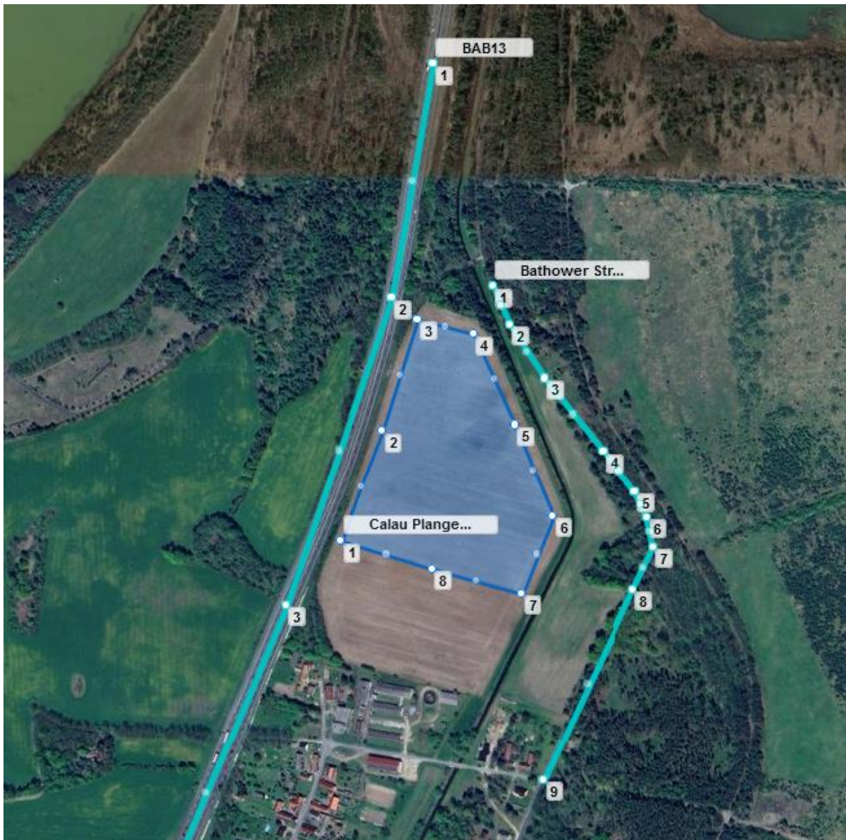
Abbildung 14: Anlage der PV-Flächen für Plangebiet 1 und Immissionsorte in der Simulationssoftware ForgeSolar
