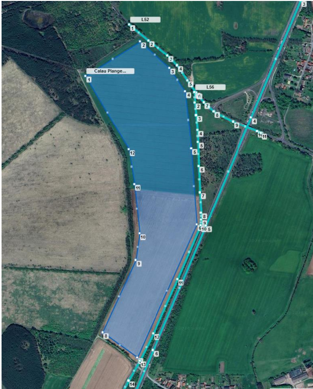
Abbildung 15: Anlage der PV-Flächen für Plangebiet 2 und Immissionsorte in der Simulationssoftware ForgeSolar
