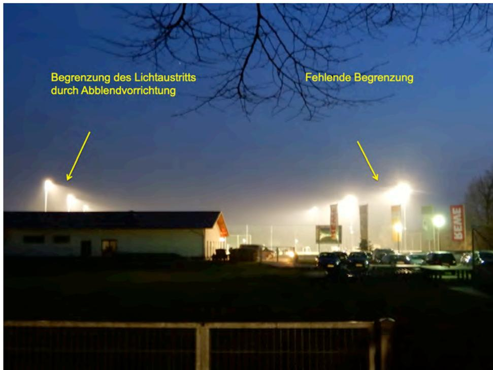
Abbildung 10: Links sind die Flutlichtleuchten zu erkennen, die nachträglich mit einer Abblendvorrichtung ausgestattet wurden, die Beleuchtung ist nach oben deutlich begrenzt. Rechts ohne Abblendvorrichtung, so dass die Beleuchtung diffus in die Umgebung streut. Foto: ibeno, 05.04.19
