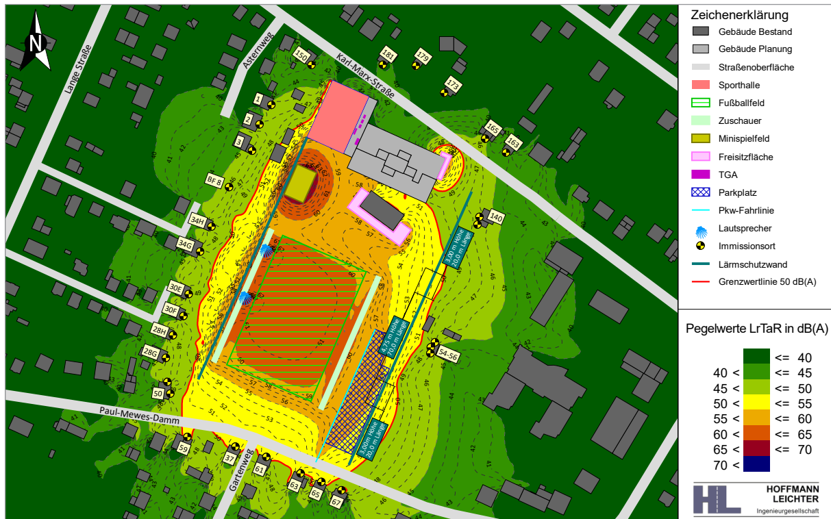
Abbildung 3-1 Isophonkarte in 5 m Höhe über Gelände | Beurteilung nach 18. BImSchV | sonn- und feiertags, außerhalb der Ruhezeiten | Schallschutzmaßnahmen mit Minispielfeld sowie abschnittsweise erhöhter Schallschutzwand Ost
