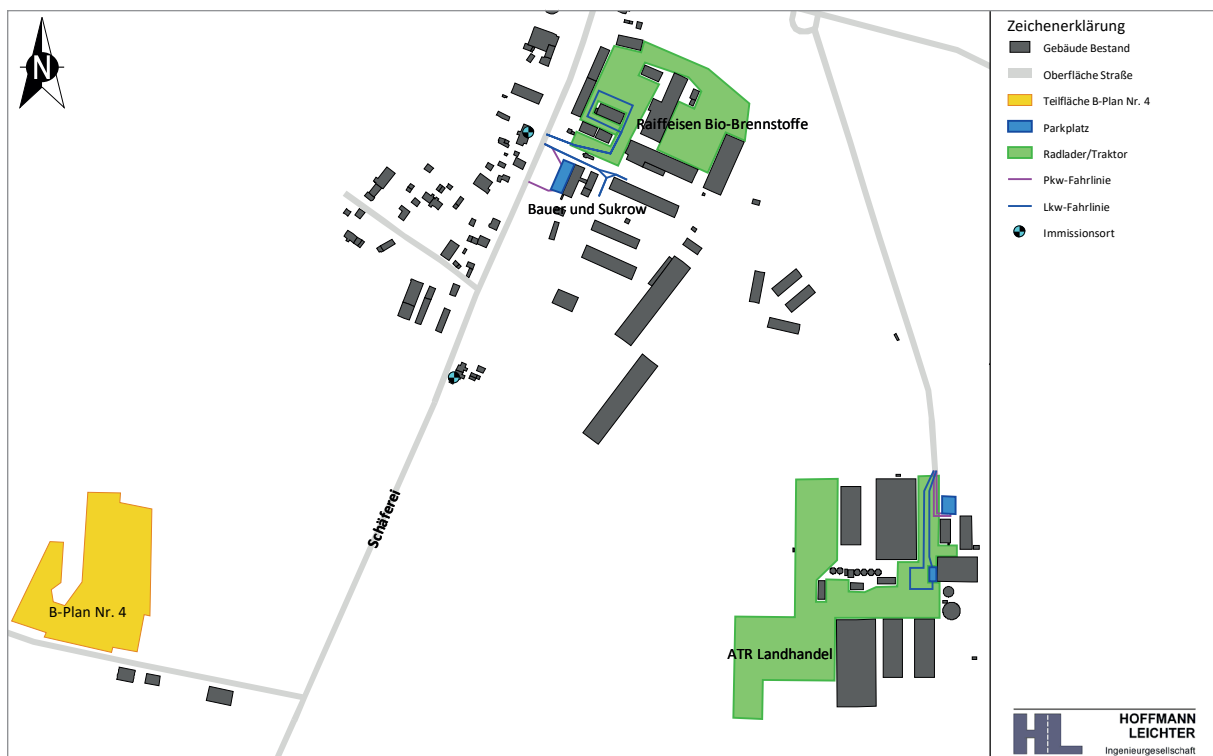
Abbildung 4-3 Anlagenschallquellen im Westen und Nordwesten des Plangebiets
