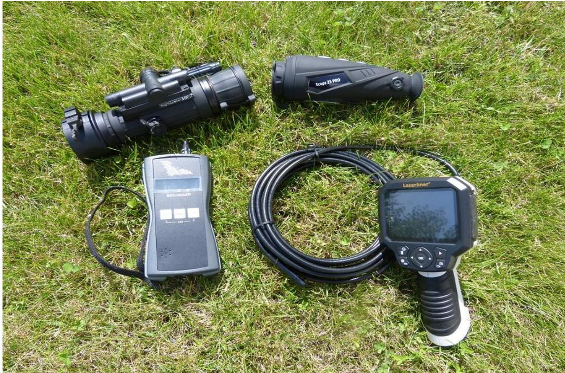
Bild 24: Endoskopkamera, Batdetektor, Nachtsichtgerät und Wärmebildkamera für Fledermausuntersuchung
