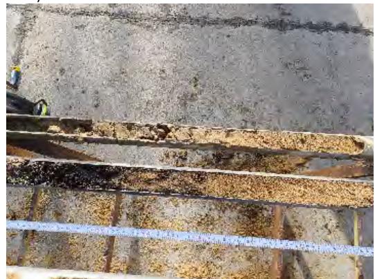
Detailansicht Bohrung RKS 9/24: Auffüllung (links unten; 0,17 – 1,4 m u. GOK), teilweise mit Kohleresten, unterlagert von autochthonem Geschiebelehm mit Schichtenwasser (unten rechts; bis 1,70 m u. GOK); Kernverlust (oben links; bis 2,30 m u. GOK); autochthone Feinsande, teilweise mit Schichtenwasser (oben rechts; bis 4,0 m u. GOK).
