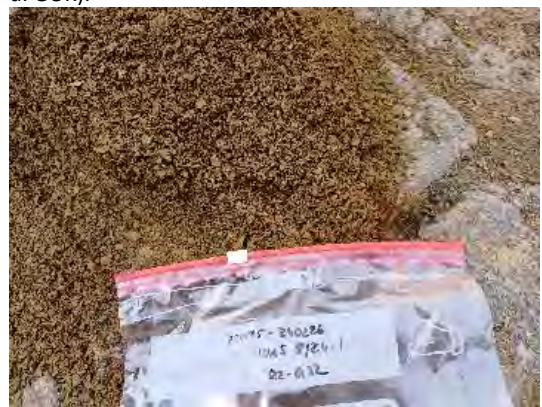
Detailansicht der Tragschicht unterhalb der Naturpflastersteine der RKS 8/24 (0,20 – 0,32 m u. GOK) aus Grus mit RC-Material.
