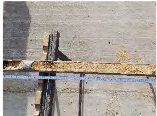
Detailansicht Bohrung RKS 2/24: Auffüllung (links; 0,22 – 0,30 m u. GOK), unterlagert von autochthonem Mittelsand (rechts; bis ca. 1,0 m u. GOK).
