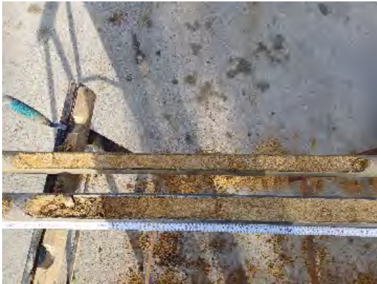
Detailansicht Bohrung RKS 3/24: Auffüllung (unten links; 0,12 – 0,40 m u. GOK) unterlagert von autochthonen Mittelsanden mit variierendem Feinkornanteil (0,40 – 4,0 m u. GOK).
