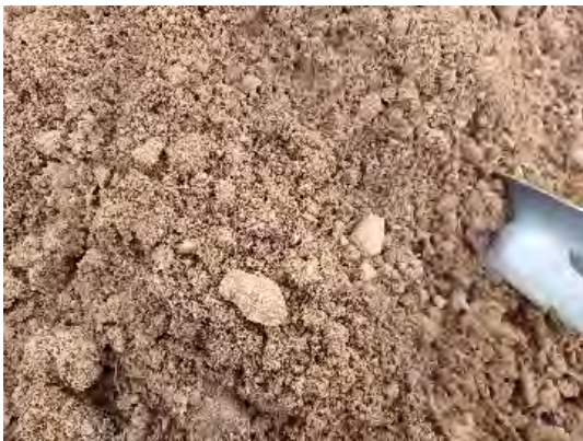
Detailansicht der MP 1, gewonnen aus den vier Handbohrung in der Aufschüttung. In den Fein- und Mittelsanden ist Beton- und Ziegelbruch vorhanden.
