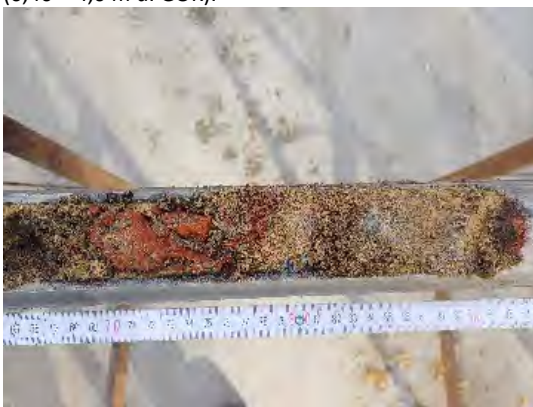
Detailansicht der RKS 6/24: Auffüllung mit Ziegel-, Beton- und Natursteinbruch (0,22 – 0,90 m u. GOK).
