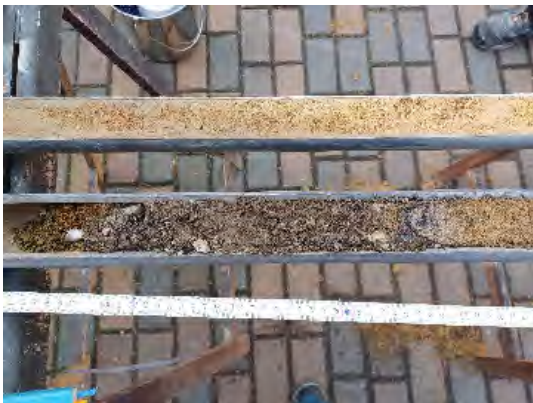
Detailansicht Bohrung RKS 8/24: Auffüllung (links unten; 0,20 – 0,90 m u. GOK), Grus mit RC-Material unterlagert von autothoem Mittelsand mit Schichtenwasser (oben; von 1,50 – 2,40 m u. GOK).
