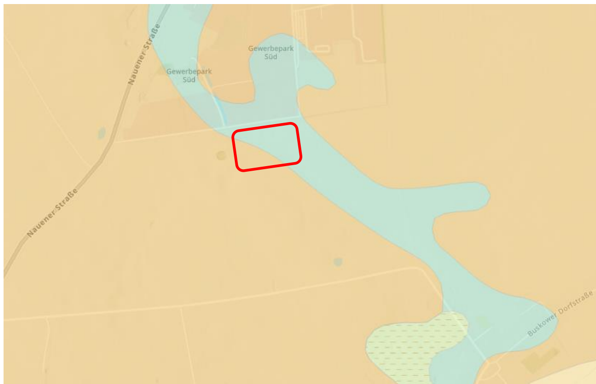
Abbildung 1: Geologische Einheiten im Umfeld des Untersuchungsgebiets (roter Rahmen) mit: Braun: Geschiebelehme und -mergel; Blaugrau: Becken- und Talfüllungen; Grün: Moorbildungen
