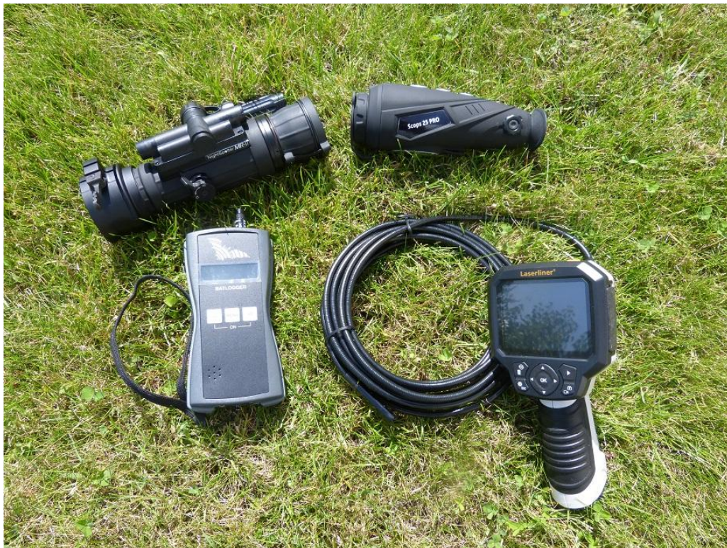
Bild 20: Endoskopkamera, Batdetektor, Nachtsichtgerät und Wärmebildkamera für Fledermausuntersuchung
