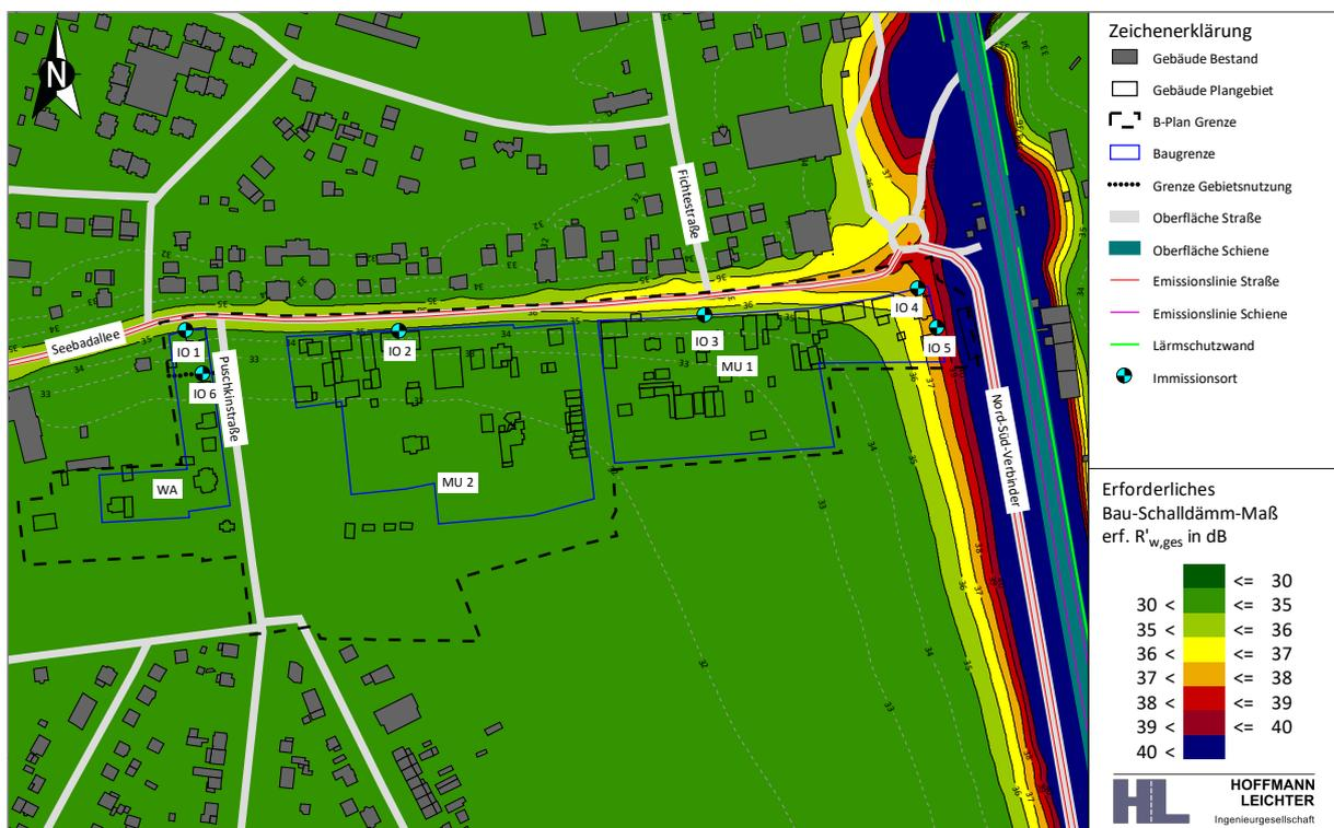
**Abbildung 12** Erforderliches gesamtes bewertetes Bau-Schalldämm-Maß gemäß DIN 4109 | Büroräume u. Ä.
