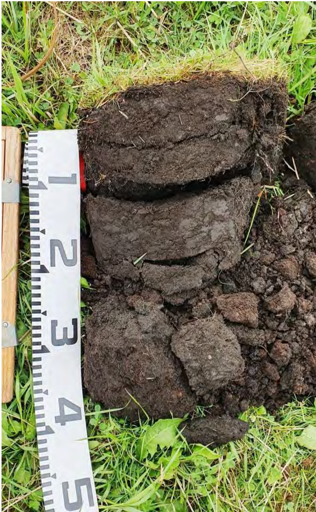
Bild 1: Profil Fehrbellin 1 (Flächenmitte) degradiertes, vermulmtes Niedermoorboden
